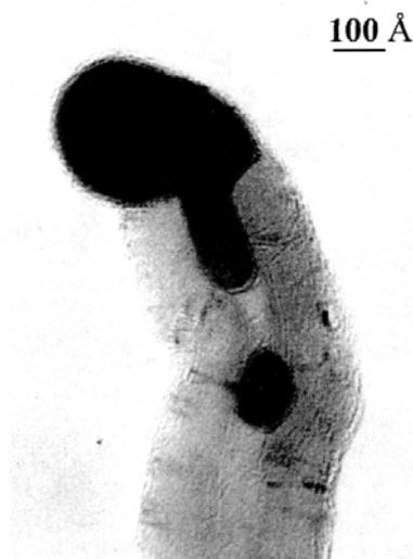
**Рис. 4.** Углеродная нанонить, образовавшаяся на металлическом железе в среде бензола, разбавленного аргоном в мольном соотношении  $C_6H_6:Ar=1:15$ , при температуре 650°C.
