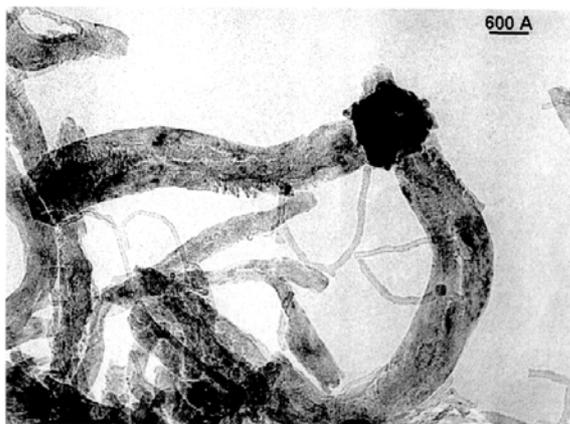
**Рис. 3.** Одновременный рост нитевидного углерода на нескольких гранях (111) частицы Ni-Cu сплава.
