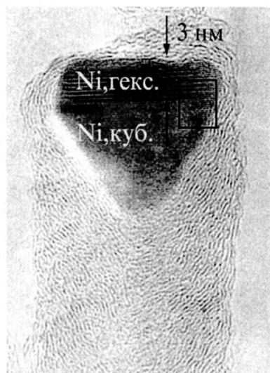
**Рис. 2.** Строение углеродной нанонити и частицы металлического никеля.  $T=400^\circ\text{C}$ ;  $\text{C}_4\text{H}_6$
