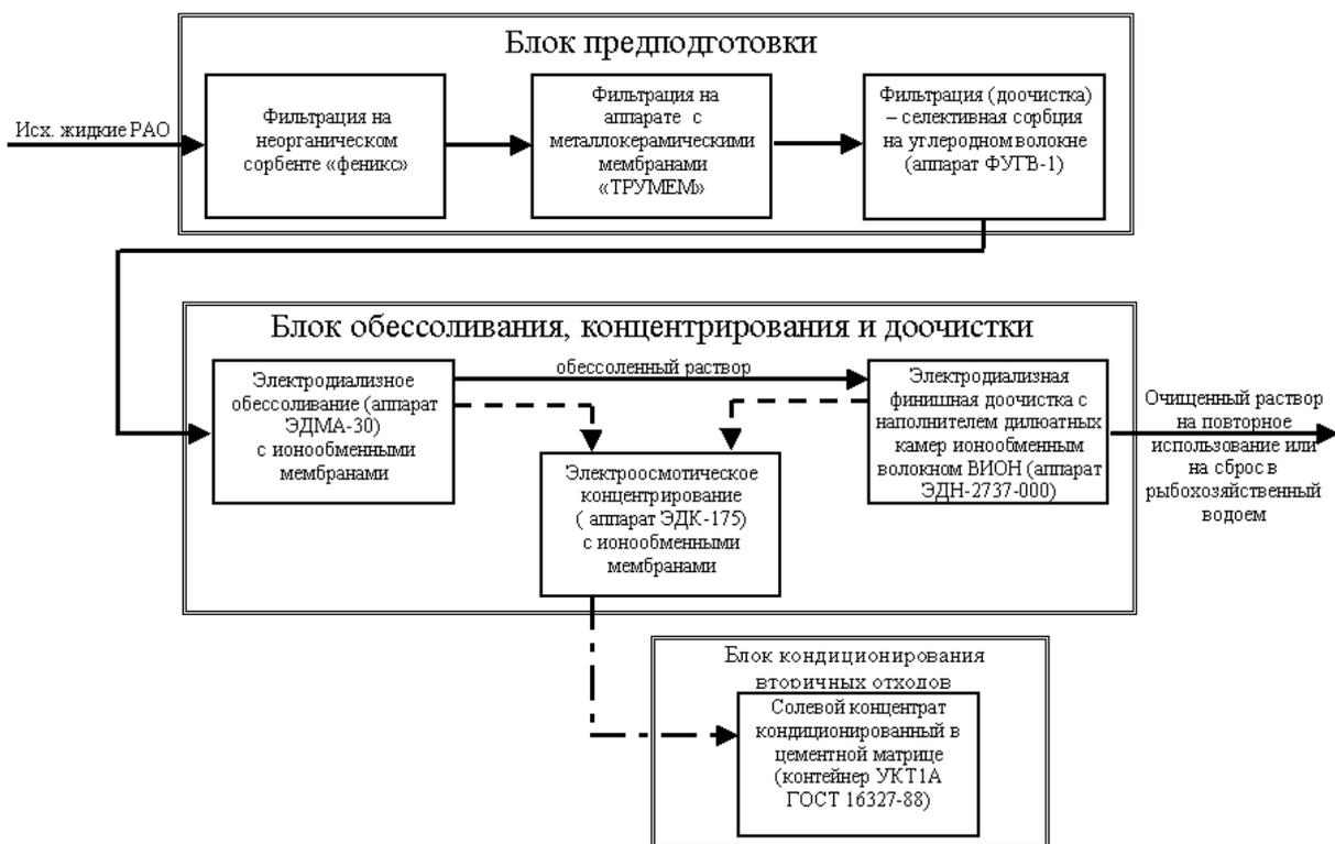
Рис. 3. Принципиальная блок-схема мембранной очистной установки ЭКО-4
