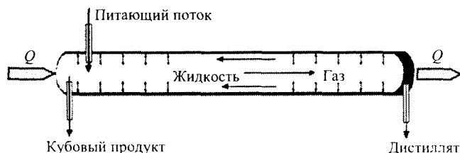
Рис. 7. Схема плоского микродистилляционного устройства с горизонтальной ориентацией колонки [15]
