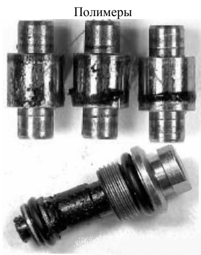
Рис. 4. Отложения полимеров на деталях
