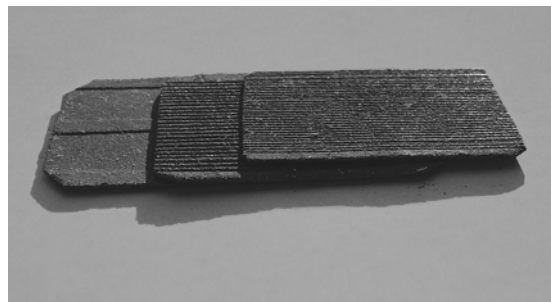
Рис. 2. МКП с прямолинейными каналами, изготовленные методом прессования из пластин пеноникеля, предварительно заполненных порошкообразным катализатором
