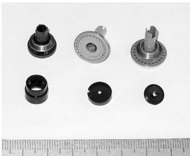
Рис. 4. Детали из стеклонаполненного полиалканимида, изготовленные литьем под давлением
