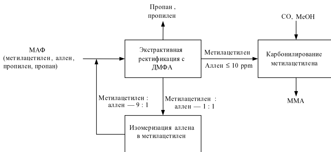
Рис. 1. Блок-схема пилотной установки получения метилметакрилата по способу Shell
