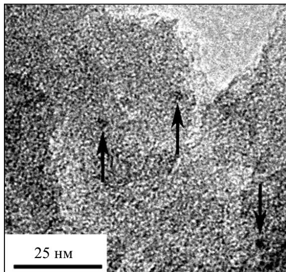
Рис. 3. Электронномикроскопический снимок палладия, нанесенного на нанопористое углеродное волокно.
