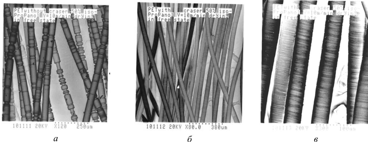
Рис. 15. Электронные микрофотографии волокон ПЭТФ, растянутых в ААС на 50%:
