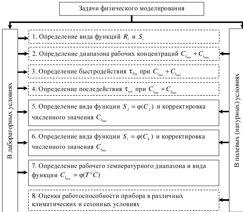
Рис. 5. Задачи, решаемые при выполнении физического моделирования процесса функционирования полевого аналитического прибора
