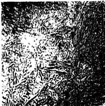
Рис. 51. Мартенсит в закаленной малоуглеродистой стали. \times 500
