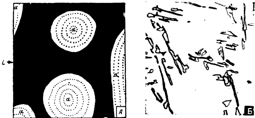
Рис. 28. Доэвтектический Al-Si 5%-ный сплав: А — расположение первичной \alpha -фазы в эвтектической жидкости, Б — конечная микроструктура после затвердевания \times 500
