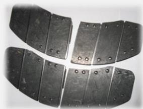
Тормозные колодки из УККМ для скоростного поезда
