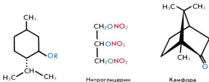
Ментол R = \text{H} Ментоловый эфир изовалериановой кислоты R = \text{COCH}_2\text{CH}(\text{CH}_3)_2
