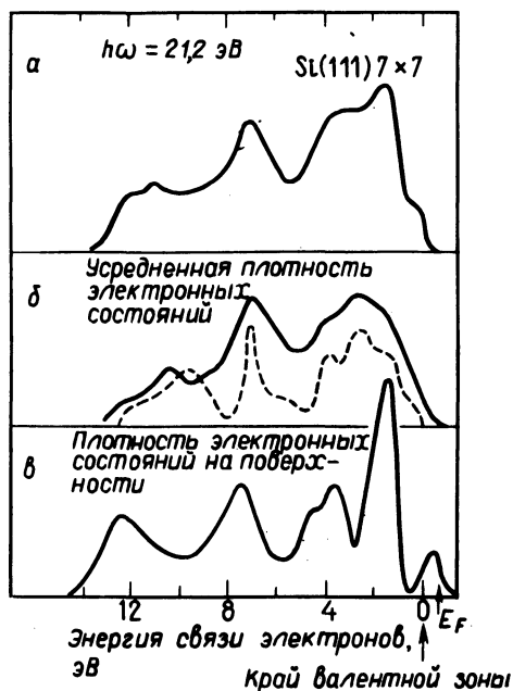
Р и с. 2.14. Спектр фотоэлектронов поверхности (111) кремния (эксперименты Роу и Ибаха, теоретический расчет Кане; рисунок взят из кн. Plummer E.W., Interaction on Metal Surface (R.Gomered.), Springer, 1975, p. 143.
