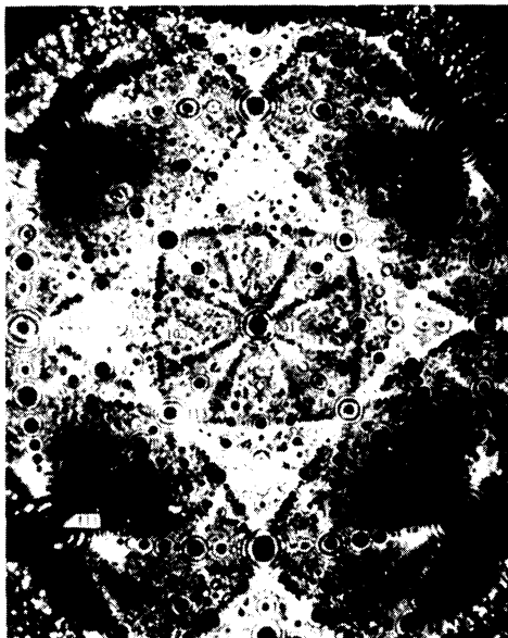
Р и с. 3.16. Изображение платинового острья, полученное методом автономной микроскопии ("проявительный" газ He, 21К) [Miller E.W., Surf. Sci., 10, 21, (1968)].
