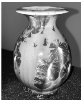
Рис. 2. Ваза (форма «Березка», ИФЗ), мягкий фарфор, покрытая виллемитовой кристаллической глазурью (3-я химическая образовательная программа, ОЦ «Сириус»). На поверхности вазы хорошо видны кристаллы виллемита
