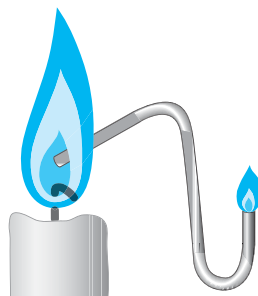
Рис. 5. Горение паров парафина, отведенных из внутренней зоны пламени свечи
