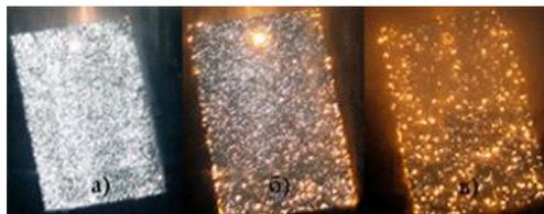
Формирование поверхностных структур на титане из электролитов, действием электрических разрядов: а и б – искровые, в – дуговые
