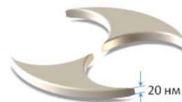
Для серебра использовали приближенную диэлектрическую функцию [3], для остальной области постоянный показатель преломления  $n=1$ . В области наночастиц использовали сетку с пространственной дискретизацией не хуже  $2,5 \times 2,5 \times 2,5$  нм.
