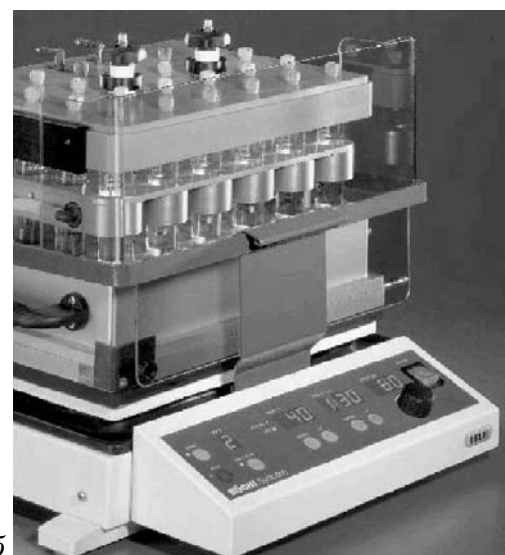
Рис. 2. Параллельное кипячение с обратным холодильником множества реакционных сосудов в системах Combi-Syn (а) и SynCore (б)
